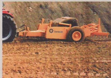
Nagy teljesítményű mély talajtömörítés
